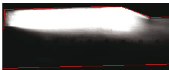
(b) 引导氢气、乙烯火焰剧烈燃烧 ( t=284.8\text{ ms} )
