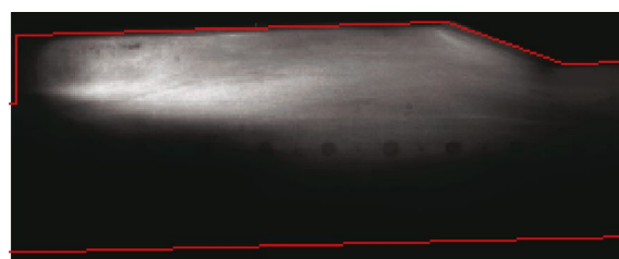
(c) 引导氢气关闭, 乙烯火焰稳定燃烧 ( t=295.0\text{ ms} )
