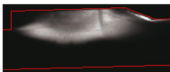
(a) 引导氢气火焰产生 ( t=232.2 ms)
